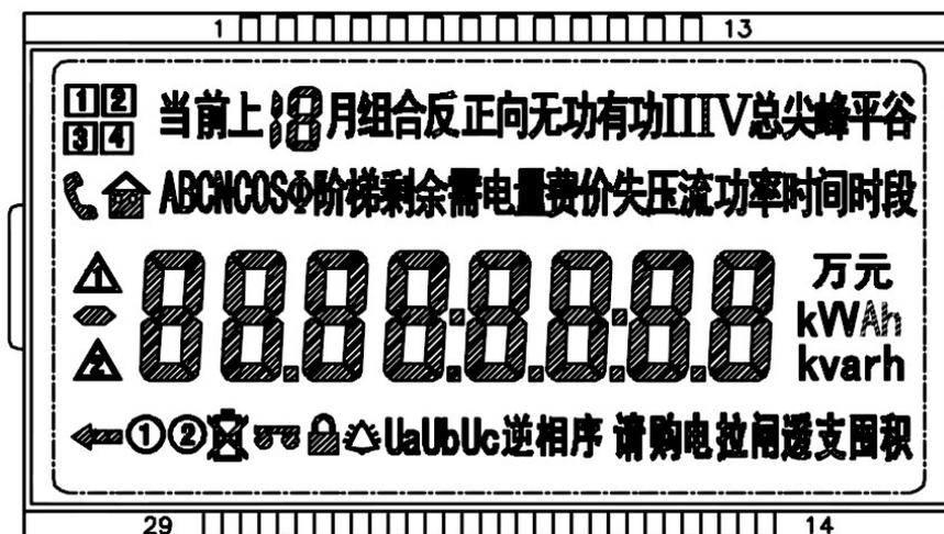
5.7.1 采用宽温大液晶方式显示各类信息；电能量显示位数为6位整数，2位小数。
